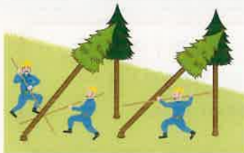
(図2)かかり木の処理
