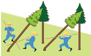
(図2)かかり木の処理
